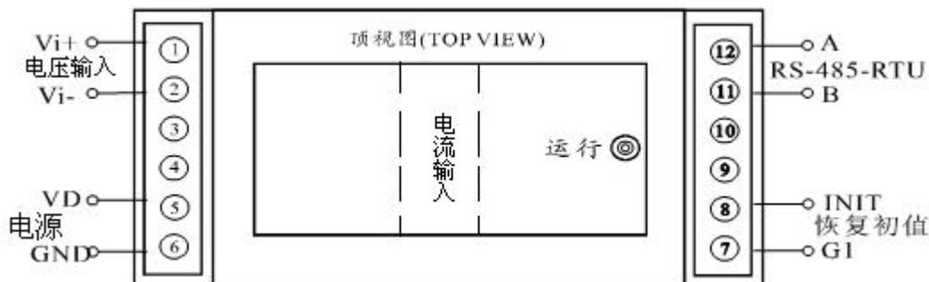
图 5.1、产品接线参考图（图为电流穿孔输入，如电流为端子输入时为 3、4 接线端子）
